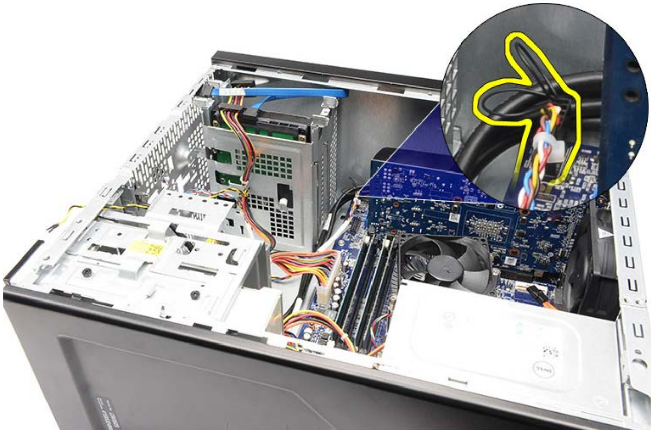
8. Fjern tænd/sluk-knappens kabel fra føringsklemmerne.
